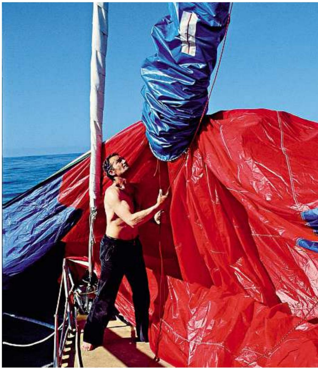
La chaussette à spi est une invention révolutionnaire permettant d'envoyer le spi rapidement, facilement et en toute sécurité.
