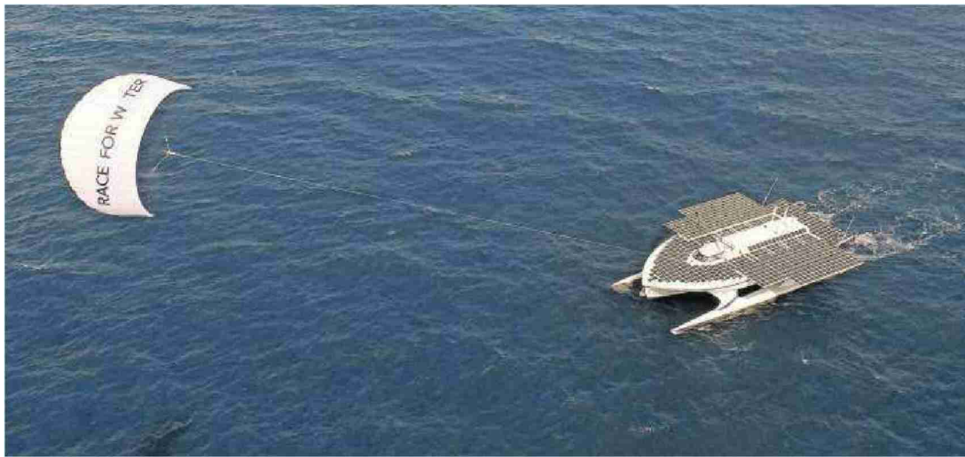
Angetrieben von Solarzellen, Wind und Wasserstoff: Der Katamaran der Stiftung «Race for Water».
