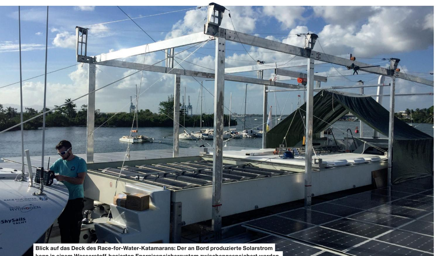
Blick auf das Deck des Race-for-Water-Katamarans: Der an Bord produzierte Solarstrom kann in einem Wasserstoff-basierten Energiespeichersystem zwischengespeichert werden.
